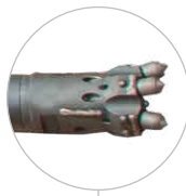
ELICON 95-Felsbohrereinheit mit Rollenmeißel
